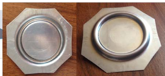
Рис. 13. Предварительно отформованное ребро жесткости
