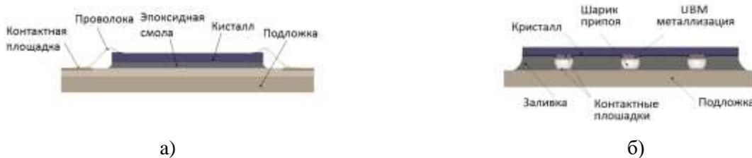
Рис. 2. Схематическое изображение метода: а) Проволочная разварка, б) Flip Chip
