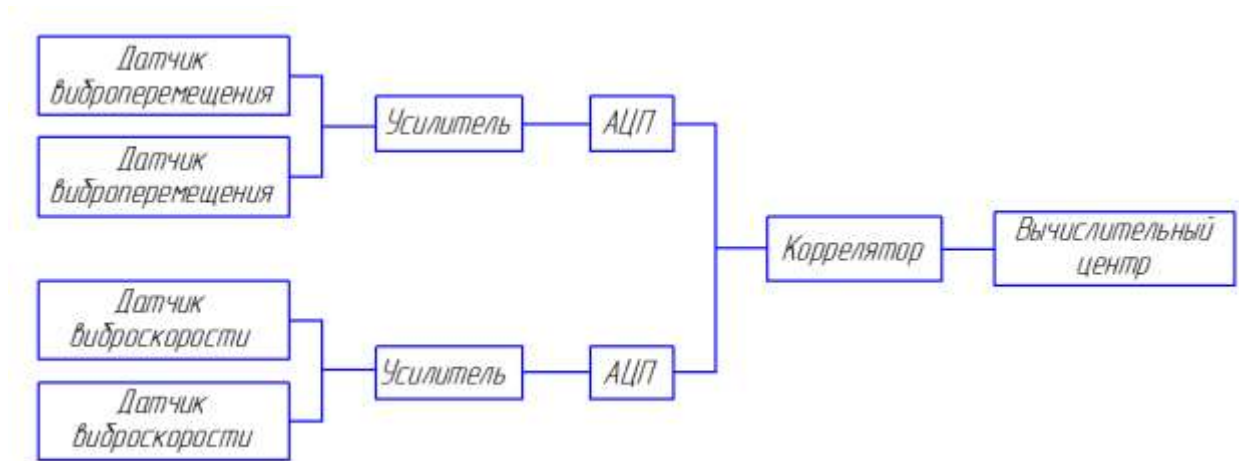
Рис. 3.- Блок – схема измерительного канала
