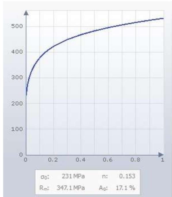
Рис. 2–б. Кривая упрочн. для слоя с Dc03
