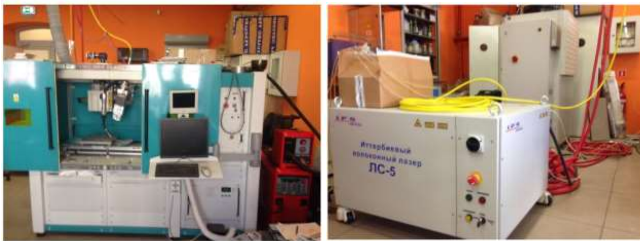
а б Рис. 1. Стенд для гибридной лазерно-дуговой сварки. а- внешний вид установки; б- волоконный лазер ЛС-5.
