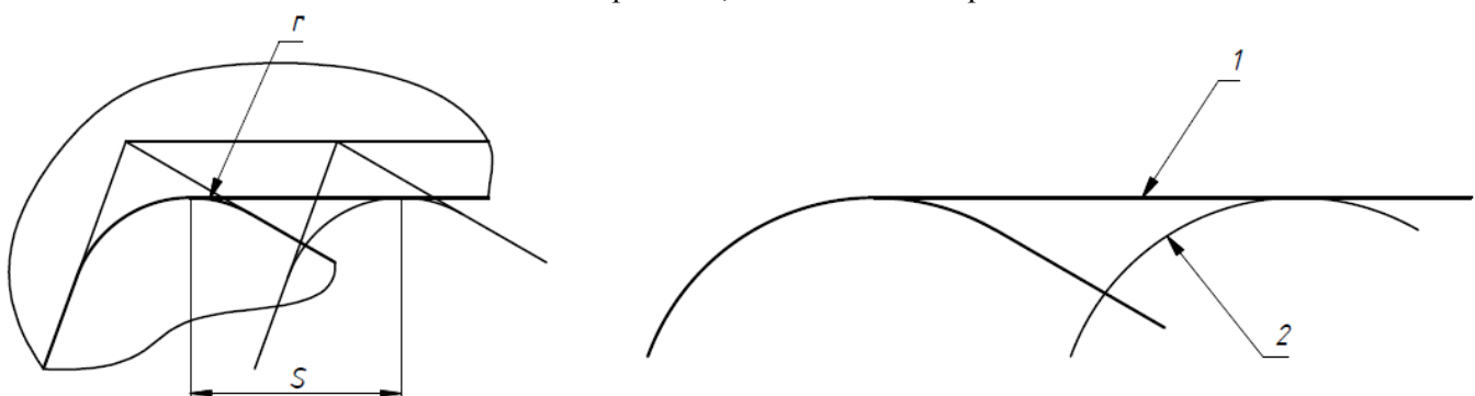
Рис.4 Случай при пересечении следов по скруглению и прямой части при \phi > \phi_1 1- Идеальная поверхность; 2- Реальная поверхность.
