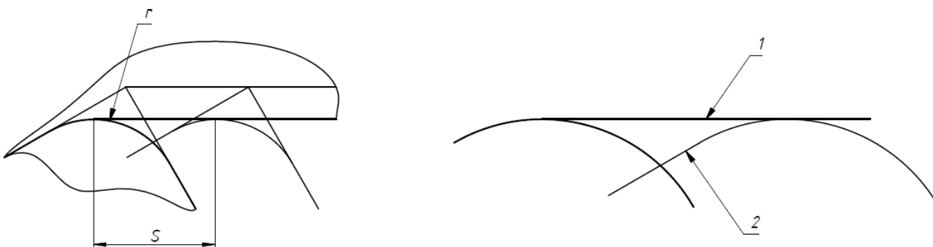
Рис.3 Случай при пересечении следов по скруглению и прямой части при \phi < \phi_1 1- Идеальная поверхность; 2- Реальная поверхность.
