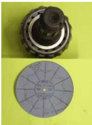
Рис.23. Круглограмма поверхности качения внутреннего кольца подшипника после запрессовки на цилиндрическую поверхность шлицевого вала.
