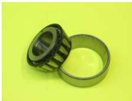
Рис. 3 Конический роликоподшипник 7807 с углом наклона поверхности качения наружного кольца  $\beta = 20$  град, внутреннее кольцо с роликами в пластмассовом сепараторе.
