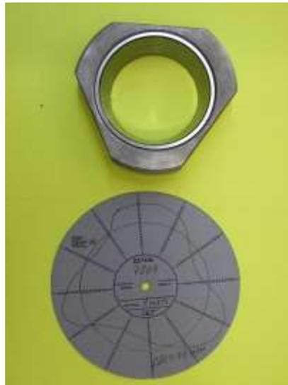
Рисунок 12 – Круглограмма поверхности качения наружного кольца подшипника после запрессовки в отверстие модели корпуса с тремя элементами снижения радиальной жесткости.
