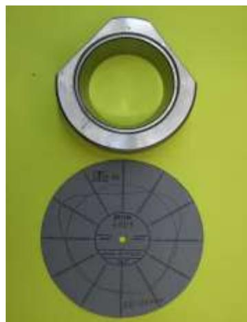
Рис.11. Круглограмма поверхности качения наружного кольца подшипника после запрессовки в модель корпуса с двумя элементами снижения радиальной жесткости.
