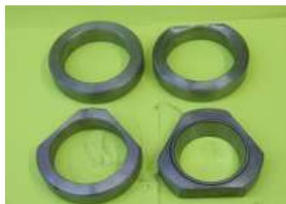
Рис. 4.Образцы моделей корпусных элементов с неравномерной окружной жесткостью для запрессовки наружных колец подшипников с гарантированным радиальным натягом в соответствии с техническими условиями предусмотренными посадками на сборку неподвижных соединений в редукторе
