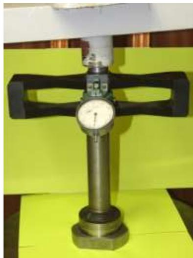
Рис.6.Тарировка индуктивного датчика для контроля силы запрессовки с помощью динамометра сжатия ДОСМ –5тс.
