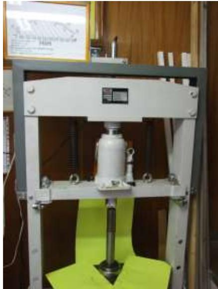
Рис.5.Пресс гидравлически для выполнения прессовых неподвижных соединений – «наружное кольцо – корпус» с контролем действительной силы запрессовки по длине контакта с помощью индуктивной измерительной системы.
