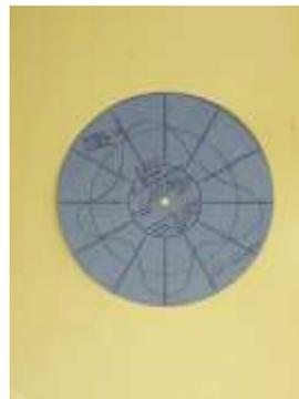
Рис. 21 Круглограмма поверхности качения наружного кольца подшипника после установки с нагревом корпуса без приложения силы от пресса после охлаждения.
