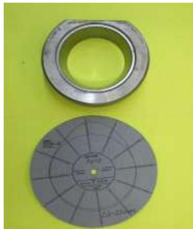
Рис.10. Круглограмма поверхности качения наружного кольца подшипника после запрессовки в модель корпуса с односторонним элементом снижения радиальной жесткости.
