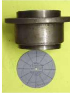
Рис.19 – Круглограмма поверхности качения наружного кольца подшипника, установленного в корпус с равномерной жесткостью но с перекосом относительно оси вращения.
