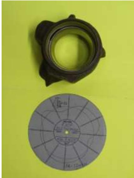
Рис.16.Круглограмма поверхности качения наружного кольца подшипника после запрессовки в горловину картера редуктора двумя ребрами жесткости и масляным каналом, исключаящим контакт поверхности кольца с корпусом.
