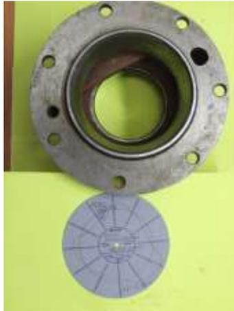
Рис.18.Круглограмма поверхности качения наружного кольца подшипника после запрессовки в корпус с погрешностью формы после расточки.
