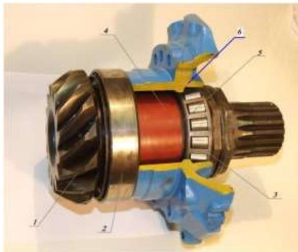
Рис. 2. Подшипниковый узел редуктора заднего моста грузового автомобиля (1 – ведущая шестерня; 2 – подшипник ведущей шестерни; 3 – внутреннее кольцо подшипника; 4 – распорная втулка; 5 – компенсатор; 6 – корпус)
