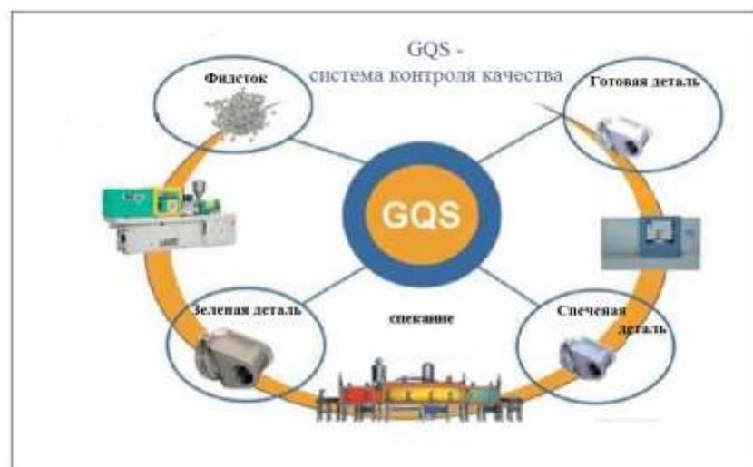
Рис. 2. Схема контроля качества при производстве деталей МІМ способом [6]
