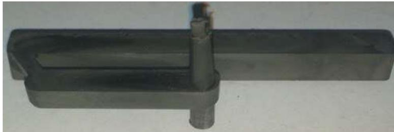
Рис. 5. «Зеленая» деталь с литниковой системой изготовлена традиционным методом изготовления
