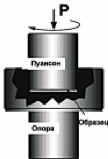
Рис.1 – принципиальная схема ИПДК
