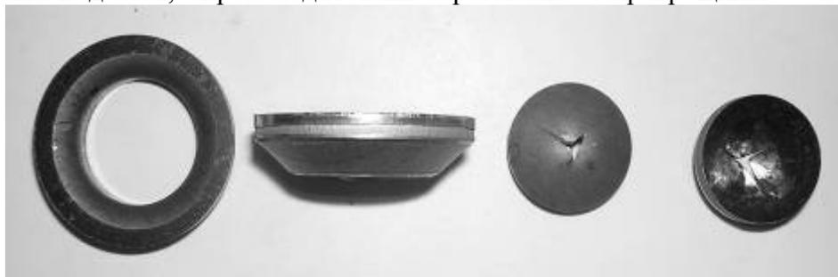
Рис. 11. Отштампованная шайба и отход пробивки отверстия при угле конусности  $X_1 = 90^\circ$  заостренной части пробивного пуансона
