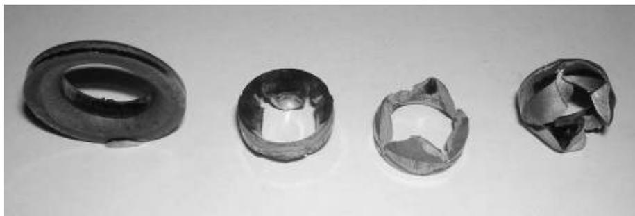
Рис. 9. Отштампованная шайба и отход пробивки отверстия при минимальном угле конусности  $X_1 = 60^\circ$  заостренной части пробивного пуансона
