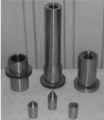
Рис. 7. Штамповая оснастка и инструмент первого перехода
