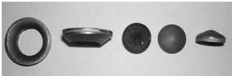
Рис. 12. Отштампованная шайба и отход пробивки отверстия при максимальном угле конусности  $X_1 = 120^\circ$  заостренной части пробивного пуансона
