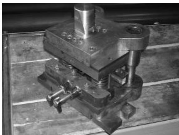
Рис. 6. Однорядный двухпозиционный штамп, используемый для проведения экспериментальных исследований
