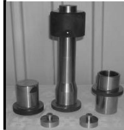
Рис. 8. Штамповая оснастка и инструмент второго перехода
