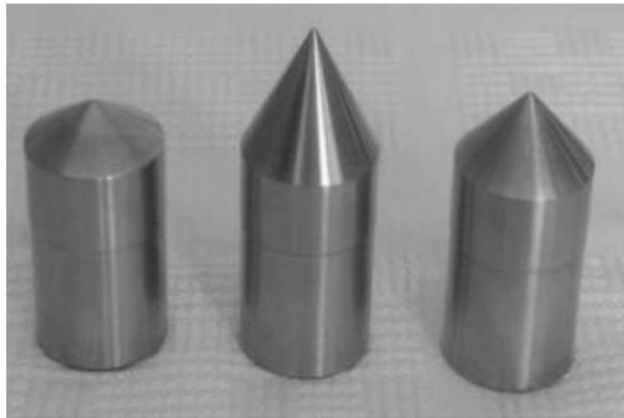
Рис. 2. Варианты пробивных пуансонов, соответствующие различным уровням фактора  $X_1$
