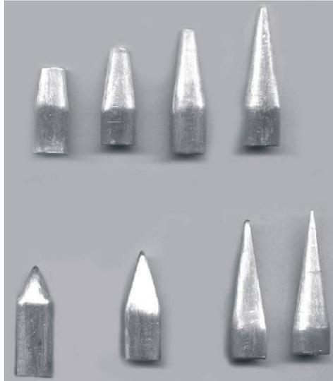
Рис.6. Образцы, отштампованные по двум вариантам технологического процесса при силе формообразования 150кН из алюминиевого сплава АМц
