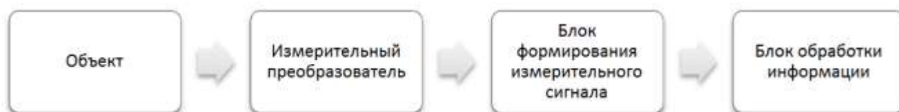
Рис. 1. Блок-схема измерительного канала
