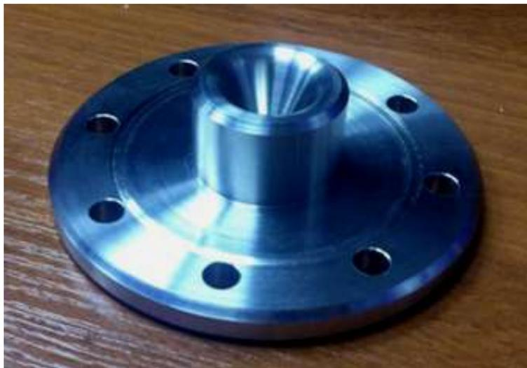
Рис. 5. Фотография спроектированного сопла
