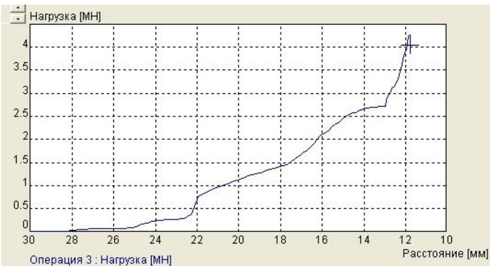
Расчет инструмента. Анализ полученных результатов для проектирования составного инструмента. Максимальные напряжения достигают 600МПа, что хорошо подходит для полугорячей штамповки.
