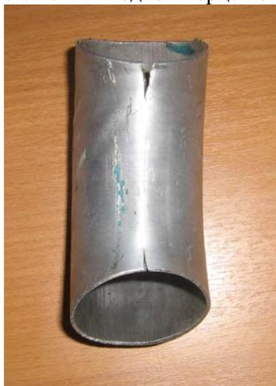
Рис. 4 – Разрушение заготовки на торцах.
