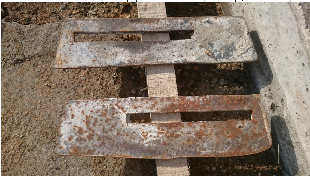
Рис. 1. Фотография скребка после эксплуатации в течение одного месяца.
