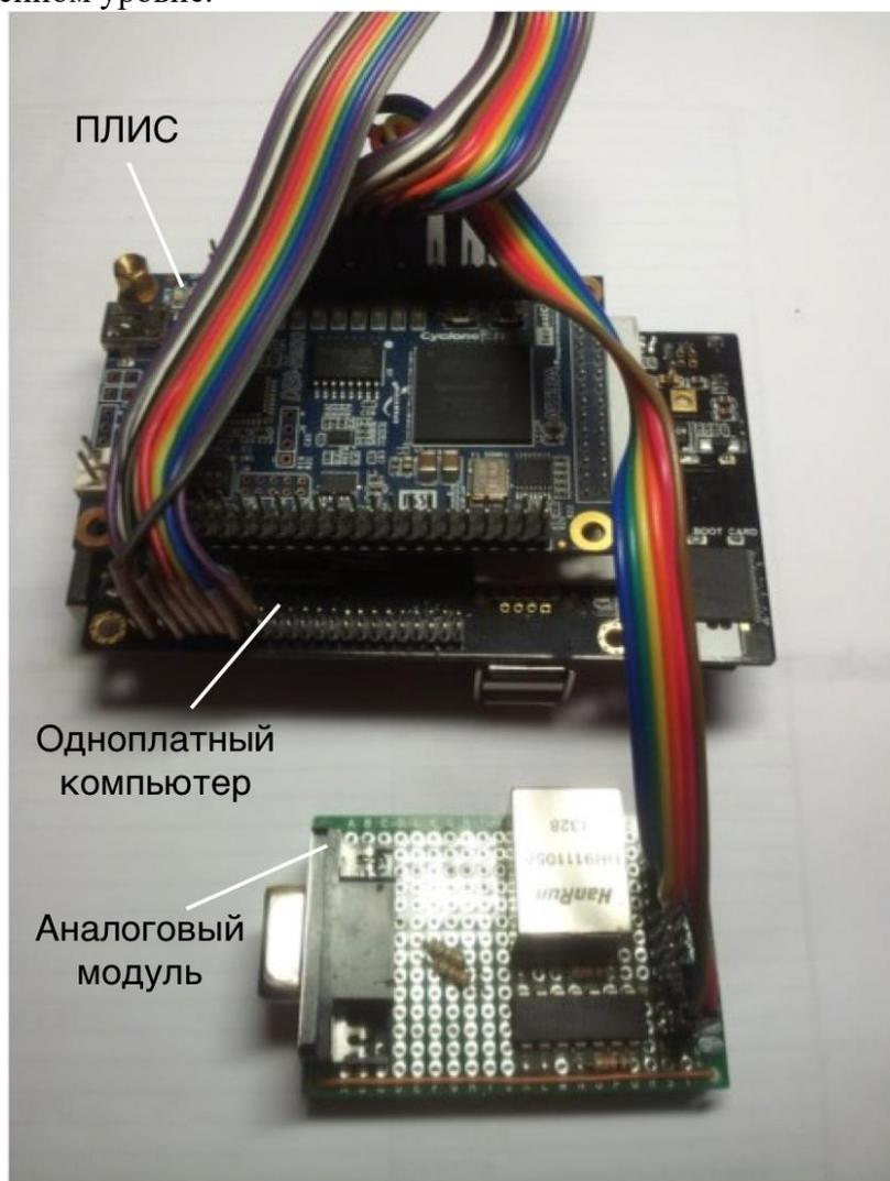
Рис. 1. Прототип системы
