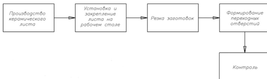
Рис.1. Существующая технология изготовления изделия
