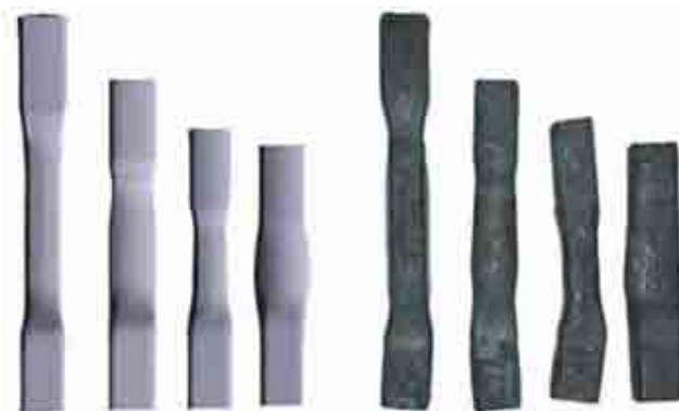
Рис. 16. Сравнение результатов моделирования вальцовки в QForm и экспериментов
