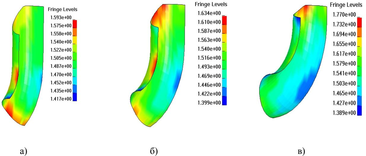
Рисунок 7 – Эпюры распределения толщин при поэтапном деформировании.
