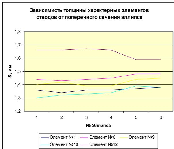
Рис. 11 – Толщина характерных элементов эллипса.
