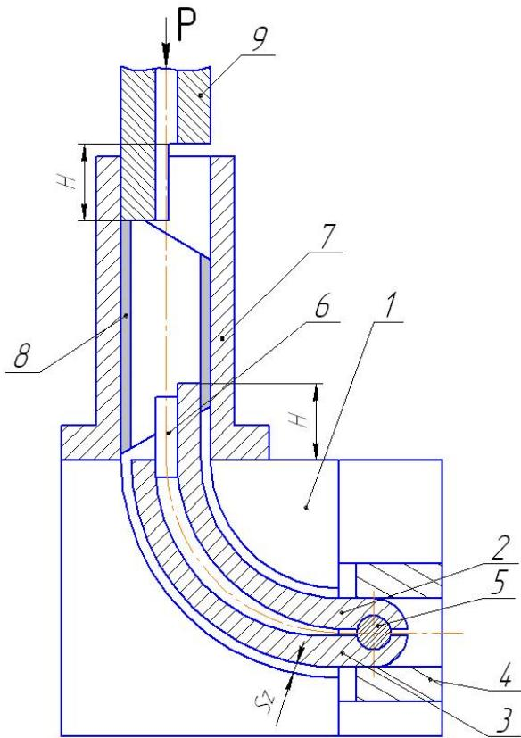
Рис. 2 – Схема устройства для формообразования тонкостенных крутоизогнутых отводов.
