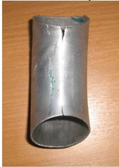
Рис. 4 – Разрушение заготовки на торцах.
