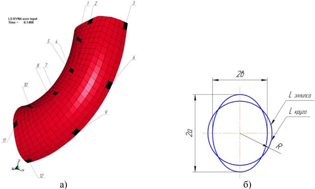
Рис.к 10 – Расположение характерных точек на отводе (а) и геометрические размеры эллипса.
