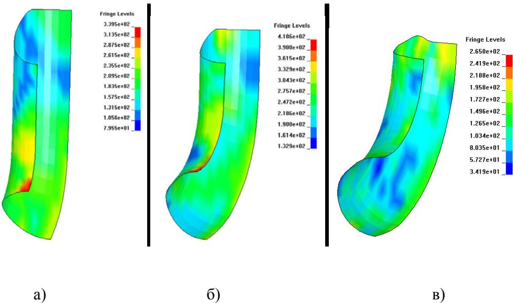
Рисунок 8 – Эпюры интенсивности напряжений при поэтапном деформировании.
