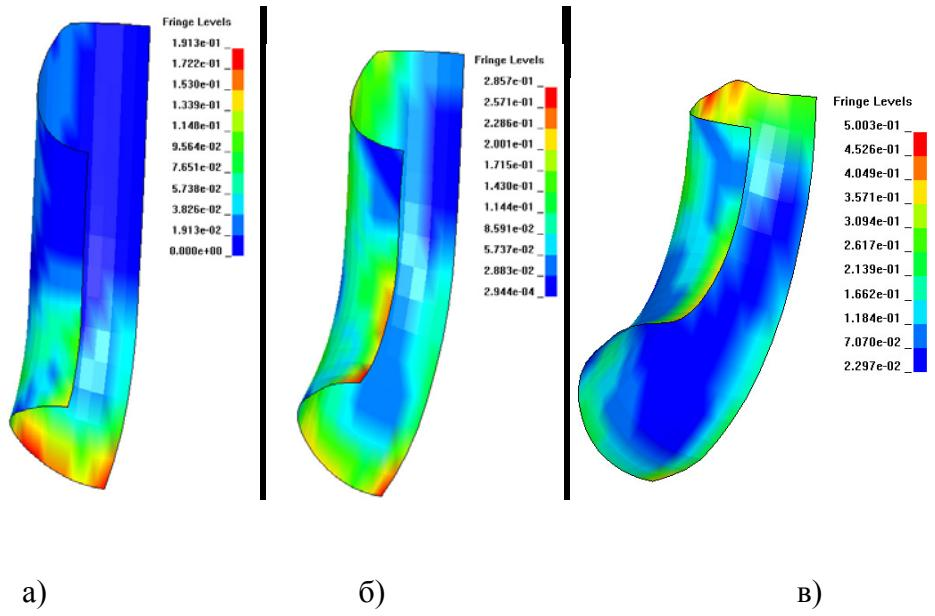
Рис. 9 – Эпюры интенсивности деформаций при поэтапном деформировании.
