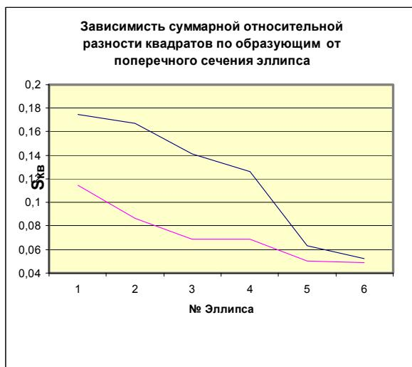
Рис. 12 – Суммарная относительная разность квадратов отклонений по толщине для образующих крутоизогнутых отводов.
