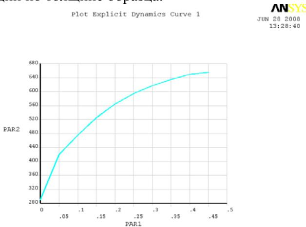
Рис. 5– Кривая упрочнения стали 12Х18Н10Т.
