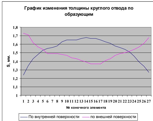
Рис. 3 - График изменения толщины отвода по образующим.
