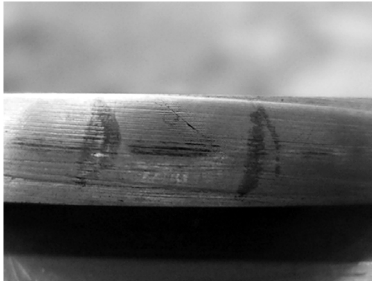
Рис.2 Место разрушения осажённого образца
