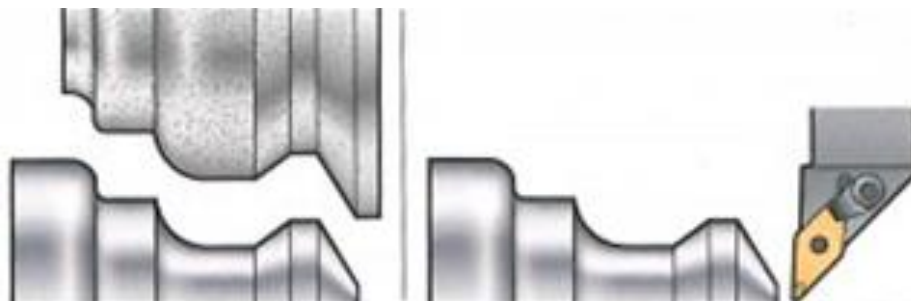
Рис. 2. Изготовление детали методами шлифования и «твердого точения»
