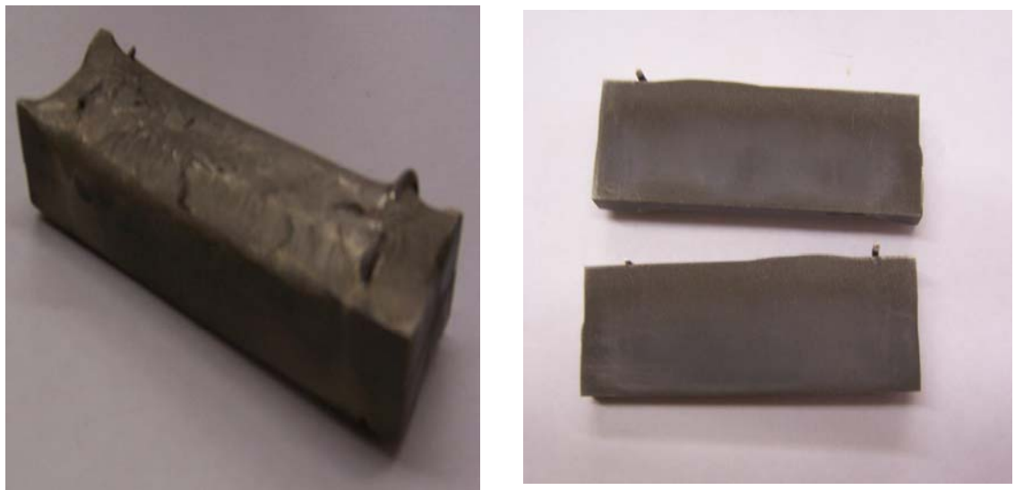
Рис.7 Образец после жидкофазного спекания электронным лучом в вакууме
