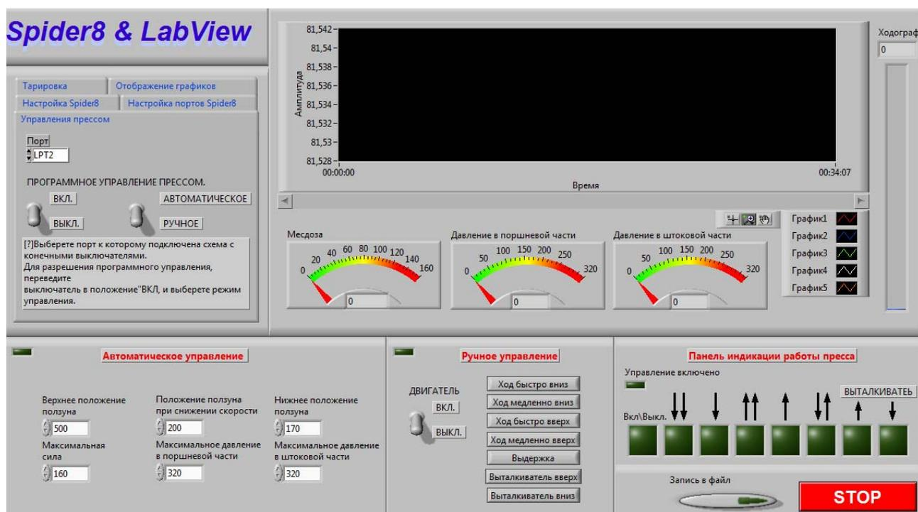
Рис. 7. Лицевая панель ВП системы управления гидравлическим прессом для ГОШ.
