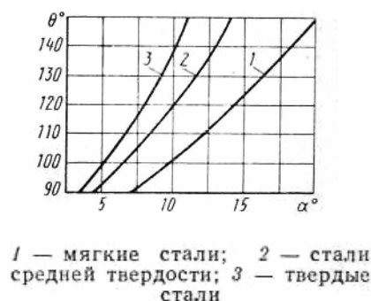
Рис. 6 График для определения угла охвата заготовки бойками
