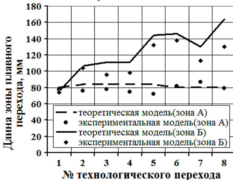
Рис. 5 Сравнение теоретических и экспериментальных данных по определению протяженности зоны плавного перехода
