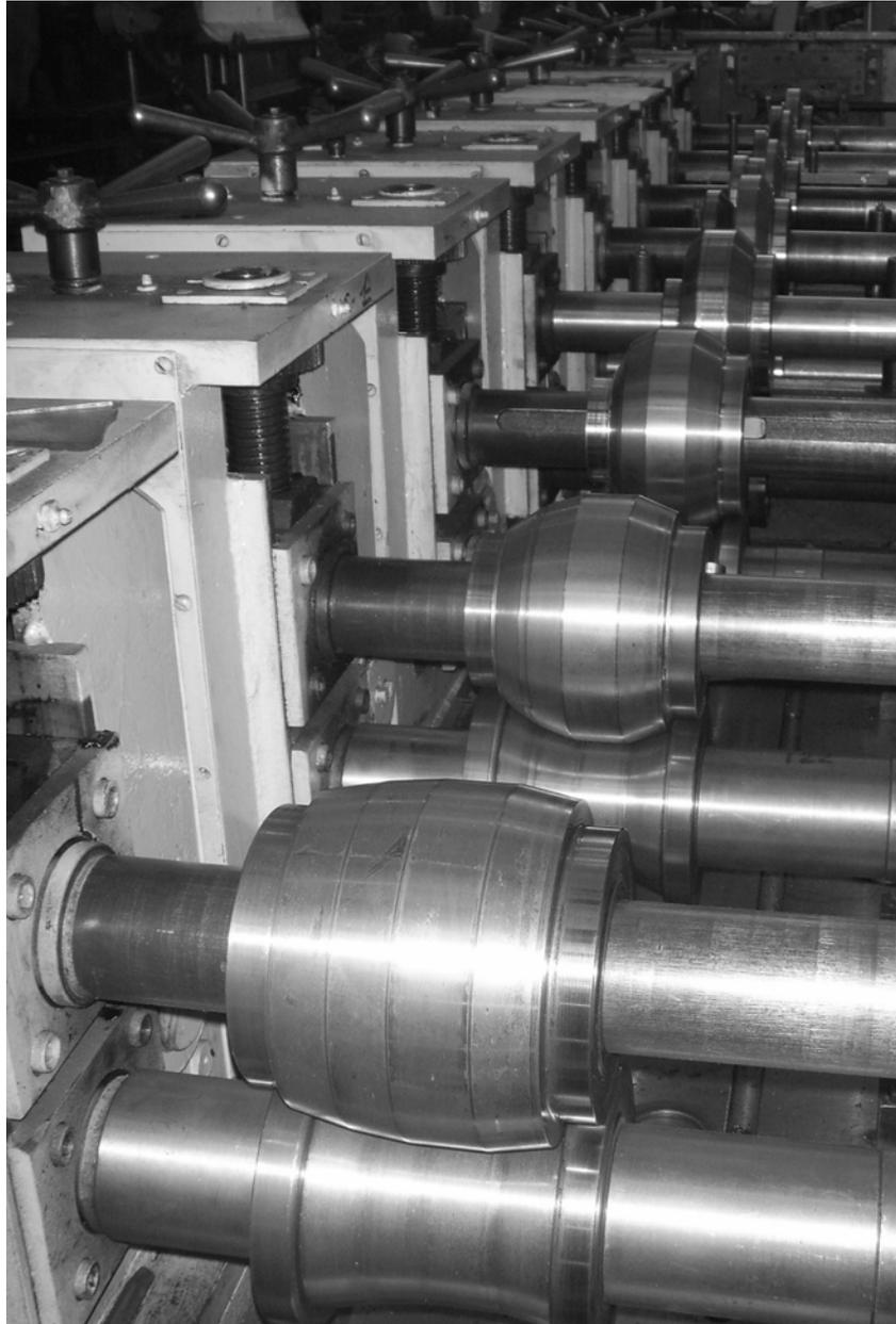
Рис.4. Профилировочный станок ГПС-350М8 с оснасткой для изготовления армирующего профиля 40,5x27,5x1,5
