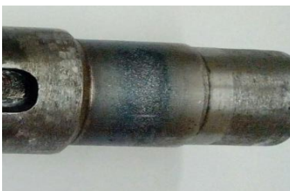
Рис. 1. Фрагмент поверхности вала с износом под подшипник качения
