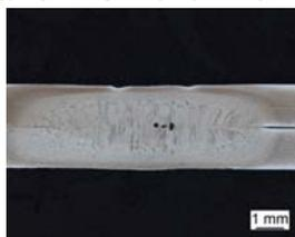
Рис. 7. Макрошлиф образца НСТ690Т+ZE75/75, сваренного контактной рельефной сваркой
