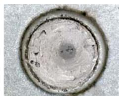
Рис. 3. Снимки соединений стали НСТ690Т+ZE75/75, выполненных контактной точечной сваркой по циклу №1
