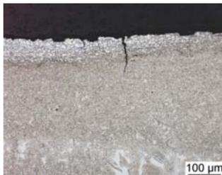
Рис. 2. Микротрещина в зоне приложения сварочной силы к образцу НСТ690Т+ZE75/75, сваренного контактной точечной сваркой по циклу №1
