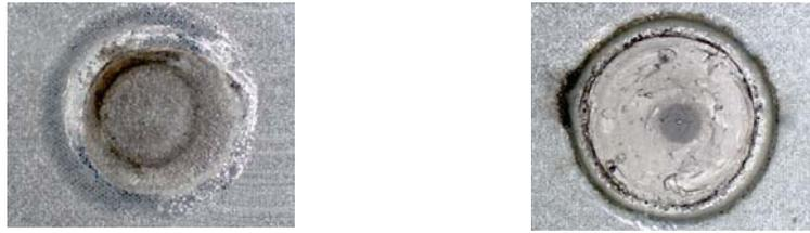
Рис. 4. Снимки соединений стали НСТ690Т+ZE75/75, выполненных контактной точечной сваркой по циклу №2
