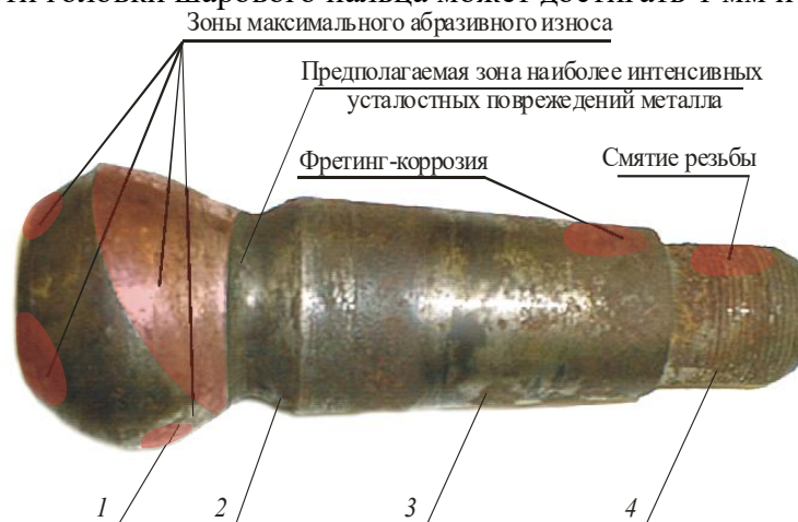
Рис.1. Зоны износа шарового пальца реактивной штанги грузового автомобиля
