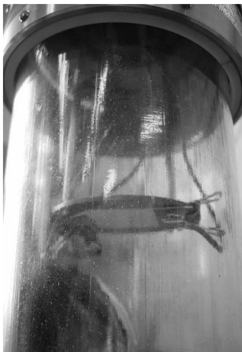
Рис. 9. Подложка установлена в рабочую камеру
