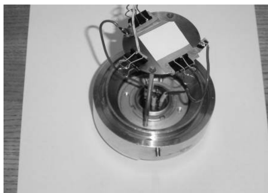
Рис. 10. Оснастка с закрепленной подложкой до (а) и после (б) проведения эксперимента
