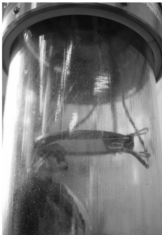
Рис. 9. Подложка установлена в рабочую камеру
