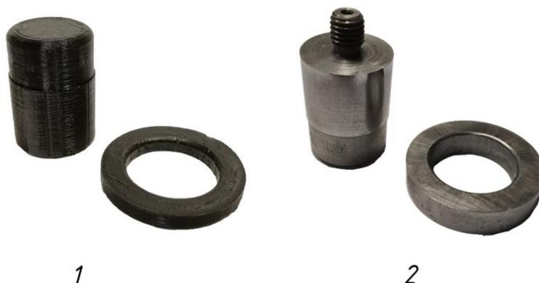
Рис. 1. Пуансон и матрица, изготовленные 3D-печатью (1) и традиционными методами металлообработки (2).
