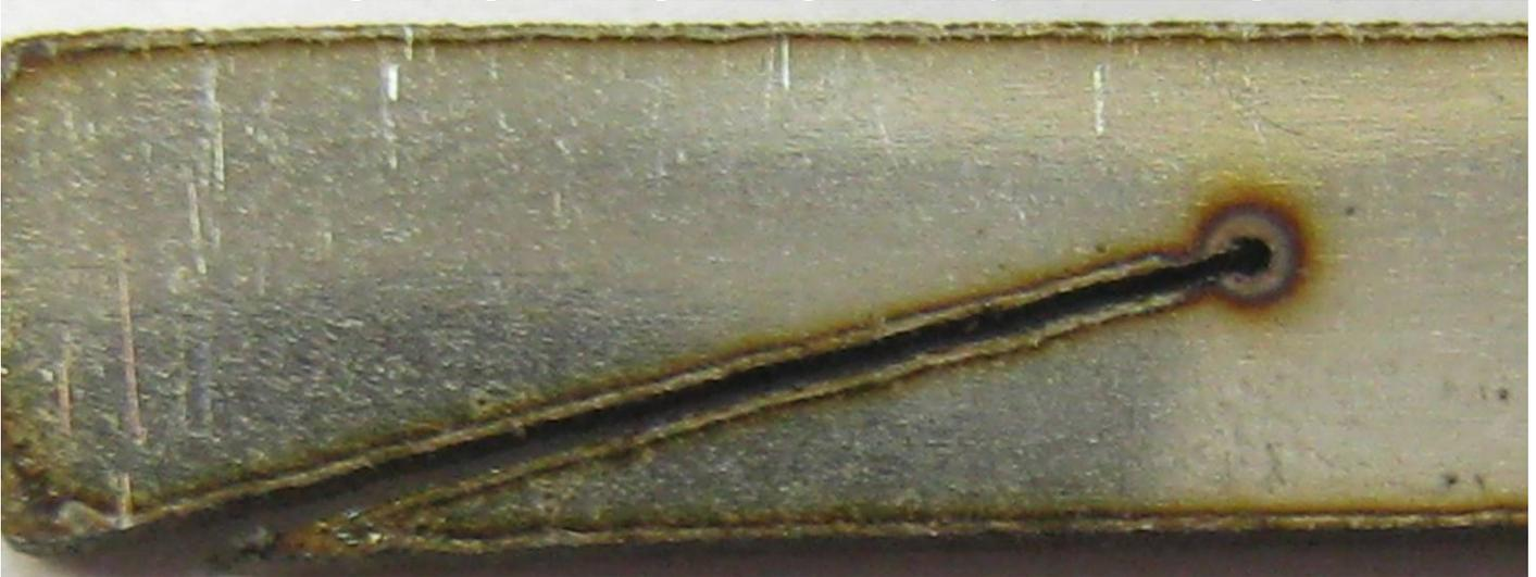
**Рис. 14. Внешний вид реза с обратной стороны. Образец №18 (увеличение в 20 раз)**
