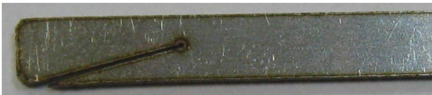
**Рис. 13. Внешний вид реза с обратной стороны. Образец №15 (увеличение в 20 раз)**
