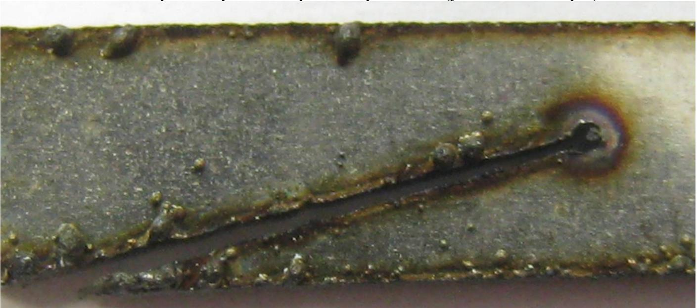
**Рис. 15. Внешний вид реза (заметна бороздчатая структура реза).**
