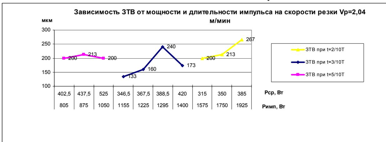
**Рис. 7. Зависимость грата от мощности и длительности импульса.**
