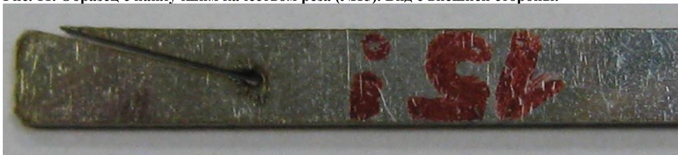
**Рис. 12. Образец с наилучшим качеством реза (№15). Вид с обратной стороны.**
