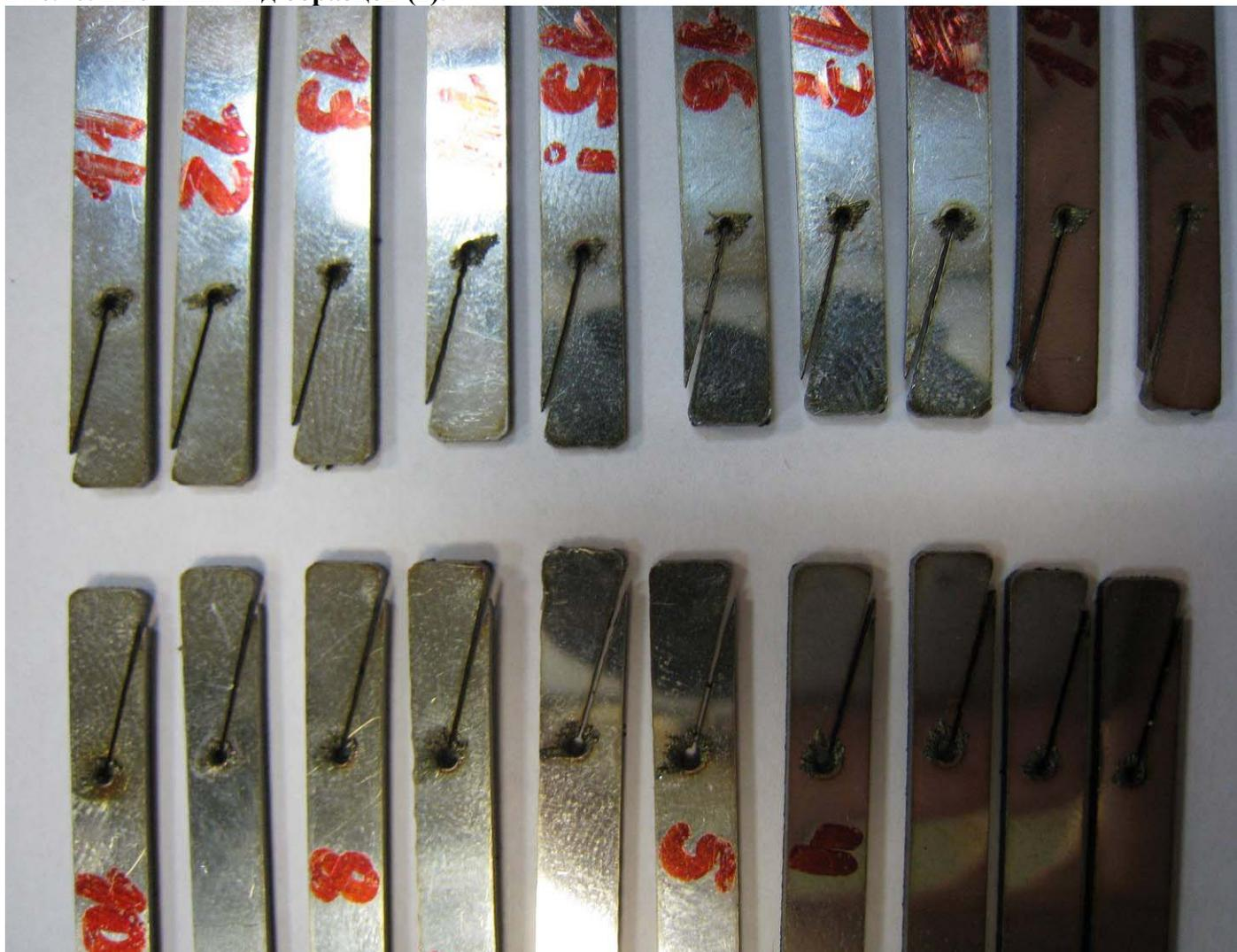
**Рис. 11. Образец с наилучшим качеством реза (№15). Вид с внешней стороны.**
