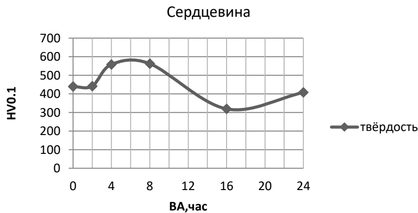
Рис.1 Зависимость твердости сердцевины от времени насыщения при вакуумном азотировании
