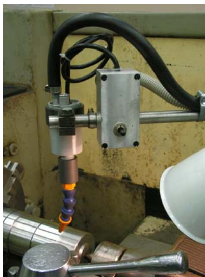
Рис. 5. УОИВ с дистанционным пультом управления, установленные на станке.
