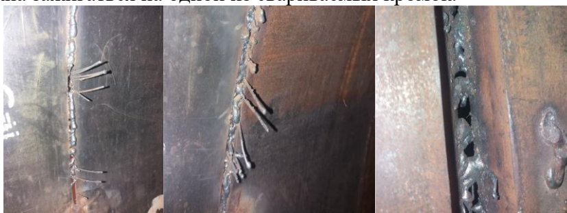
Рисунок 1. Несплавление кромок и попадание проволоки в зазор
