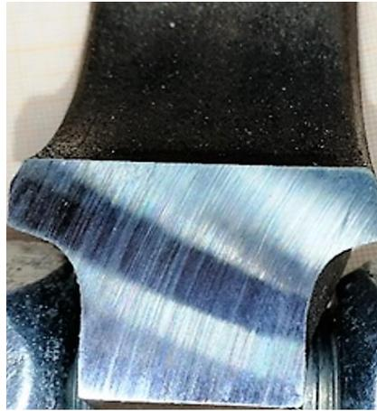
Рисунок 3. Поперечный разрез нижней крышки шатуна с нанесённым покрытием
