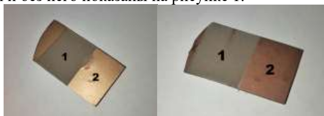
1 - эластомер, 2 - медное покрытие на эластомере
