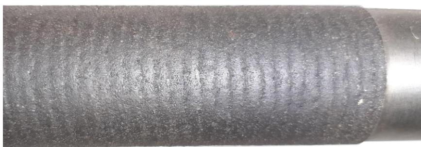
Рис. 4. Поверхность вала после проведения плазменно-порошковой наплавки
