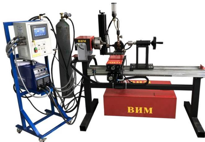
Рис.1. Общий вид автоматической установки для плазменно-порошковой наплавки
