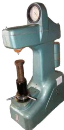
Рис. 6. Стационарный твердомер Роквелла ТК-2М
