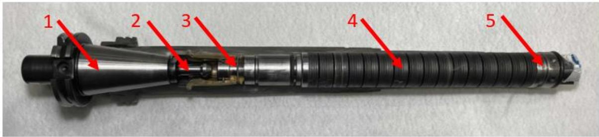
Рис. 2. Макет механизма фиксации оправки типа SK-40: 1 – Инструментальная оправка; 2 – штремель, 3 – сегментная цанга, 4 – пакет тарельчатых пружин, 5 – шток системы фиксации.
