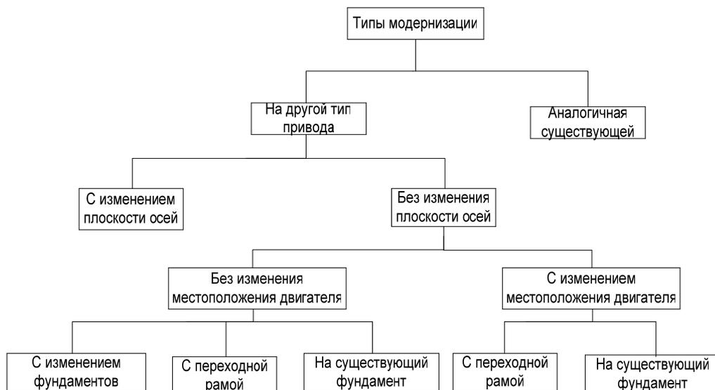
Рис. 3. Основные варианты модернизации приводов.
