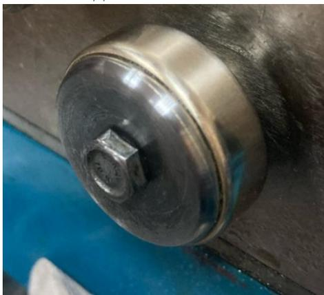
Рис. 1. Ролик с покрытием, нанесенным методом ФАБО
