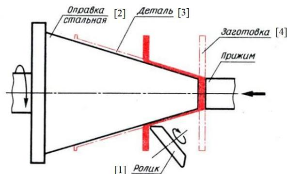
Рис.1 – Сущность процесса ротационной вытяжки. 1 — обжимной ролик; 2 — вращающаяся оправка; 3 — получаемая деталь; 4 — плоская заготовка;
