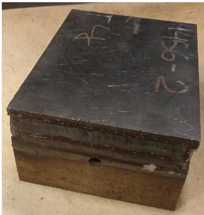
Рис. 2. Биметаллический пакет после сварки
