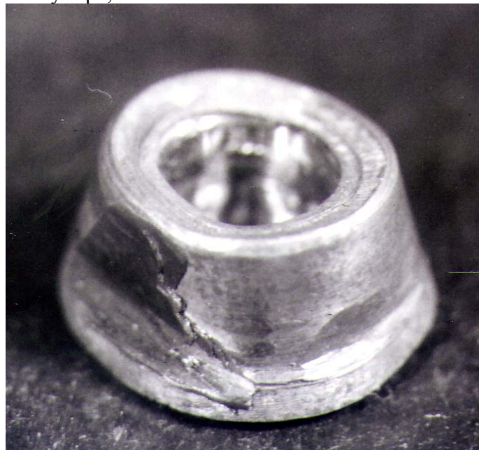
Рисунок 4— Заготовка, заклиненная в роликовой матрице
