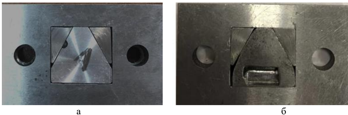
Рис.4. Исходный (а) и восстановленный образец (б)
