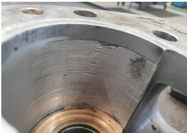
Рис. 1. Дефекты на стенках корпуса шестерённого насоса
