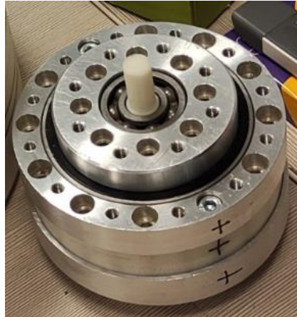
Рис. 2. Прототип планетарно-цепочного редуктора с механизмом параллельных кривошипов
