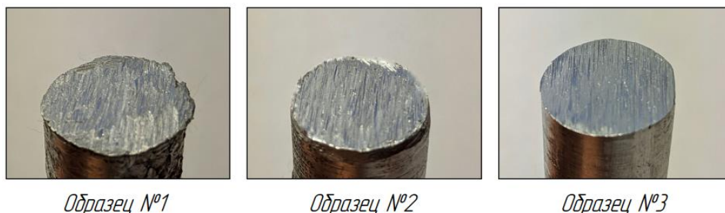
Рис. 1. Внешний вид образцов после испытаний на износ
